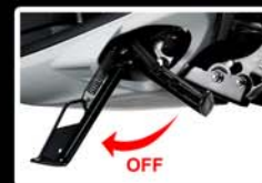
Smart Stand Switch Sistem yang membantu keamanan pengendara.
