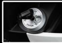
Integrated Key Shutter sebagai pengaman ganda sekaligus pembuka bagasi.
