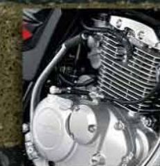
MESIN KOKOH HALUS GETARAN Mesin generasi baru dilengkapi engine balancer sehingga mesin lebih halus.
